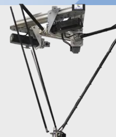
Nevlabsc. Дельта-робот сортировщик мусора.
